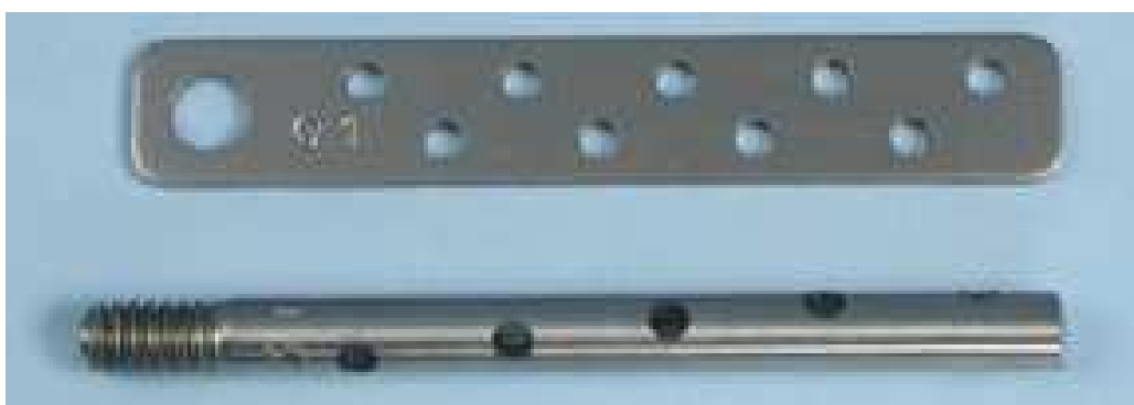
3.7 pav. Korozijos ir nuovirų susidarymo indikatoriai
