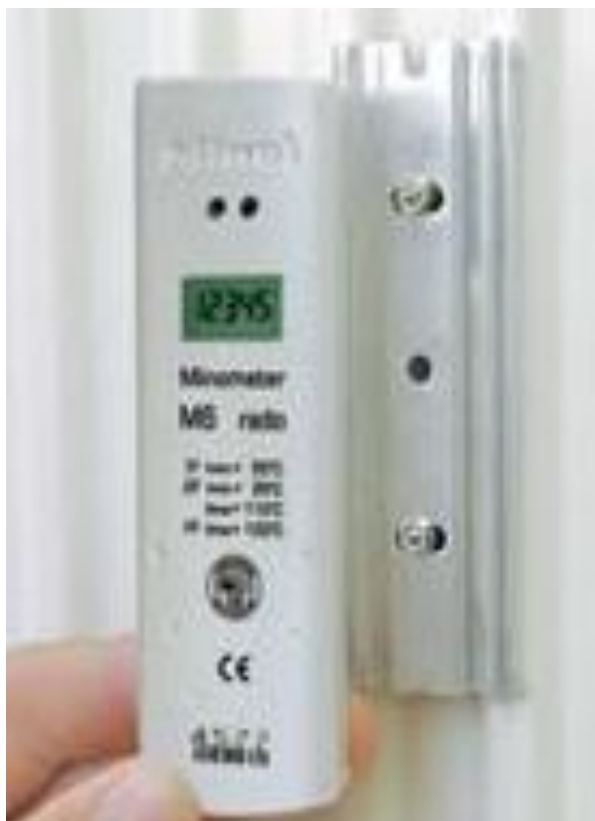
3 paveikslas. Elektroninis šilumos daliklis. Gali būti montuojamas ant to pačio pagrindo, ant kurio buvo sumontuotas ampulinis šilumos daliklis (žr. 1 paveikslą). Rodmenys išvedami į ekranėlį. Be to, rodmenys gali būti perduoti tam tikrą nedidelį atstumą iki priimančiojo įrenginio. Taigi jiems galimas nuotolinis duomenų nuskaitymas.
