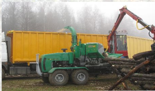
Производство щепы из низкокачественной древесины
